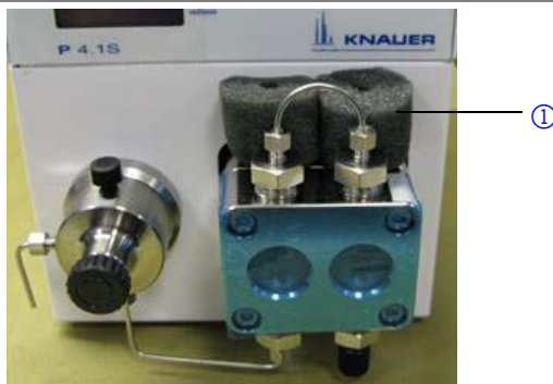
Abb. 5 Transportschutz zwischen Enden der Pumpenkapillaren und Gehäuse
