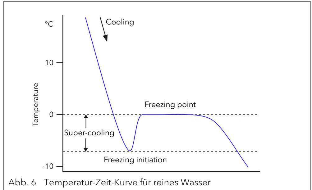
Abb. 6 Temperatur-Zeit-Kurve für reines Wasser
