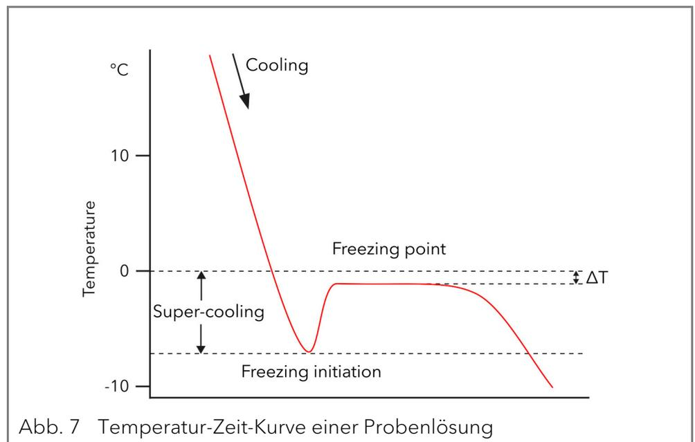
Abb. 7 Temperatur-Zeit-Kurve einer Probelösung
